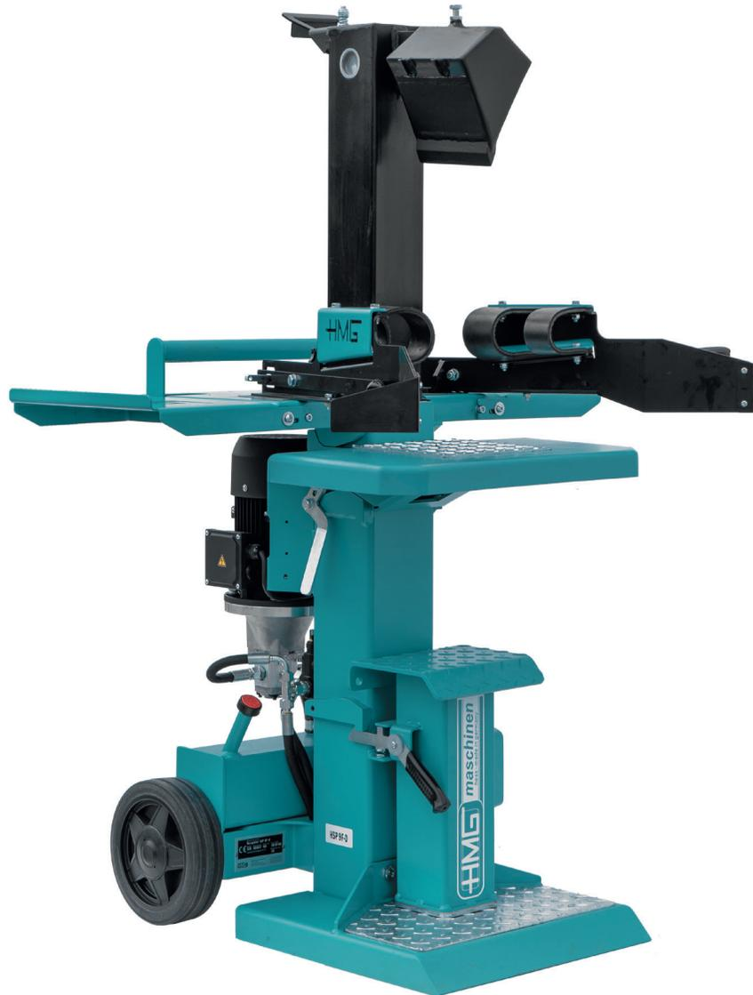
Der HMG Kurz- und Meterholzspalter der Serie HSP 9F ist für längere Einsätze gebaut, um Brennholz bis 123cm Länge aufbereiten zu können. Mit 9t Spalkraft sind auch mal schwierigere Spaltleistungen abrufbar. Mit Kurzholztisch können Holzstücke bis
